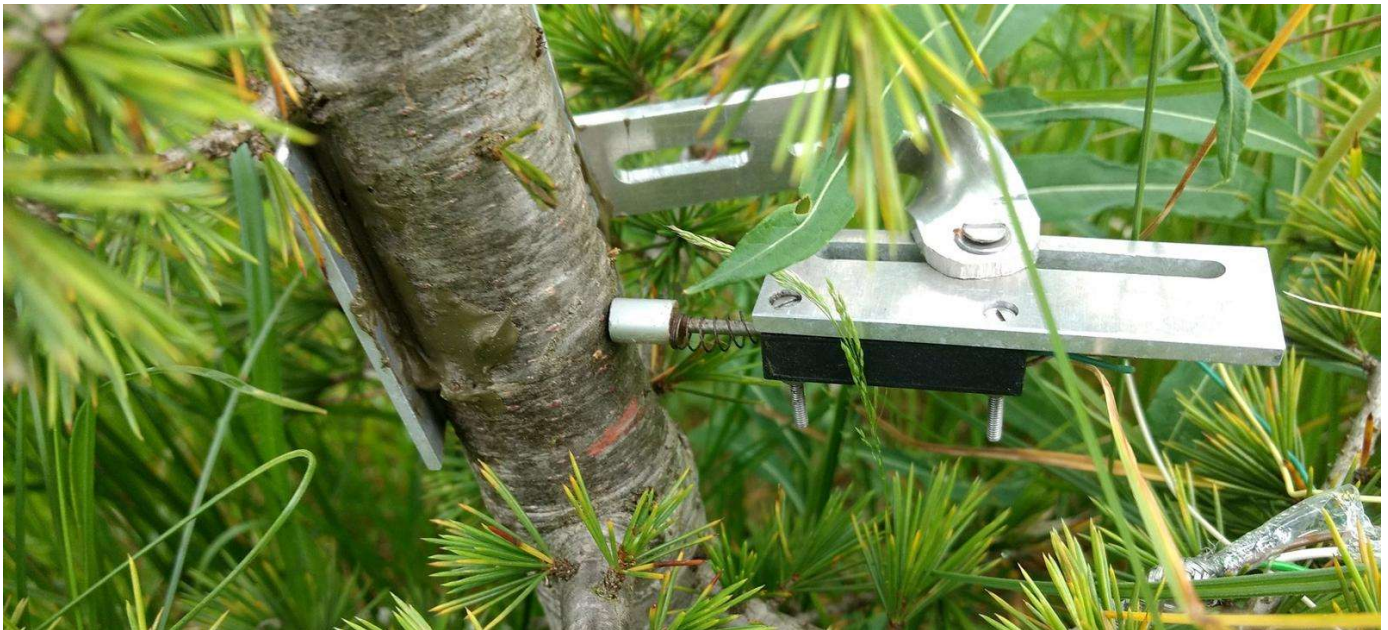
Abb. 4: Mit Hilfe von Dendrometern lassen sich die täglichen Veränderungen des Stammdurchmessers ermitteln. Die hochaufgelösten Messungen zeigen die unmittelbare Reaktion der Bäume auf Veränderungen von Lufttemperatur und Niederschlag. Daraus ergeben sich unter anderem Erkenntnisse über die Anpassungsmöglichkeiten der untersuchten Baumarten an Trockenheit (Foto: V.Horna, Universität Bayreuth).
